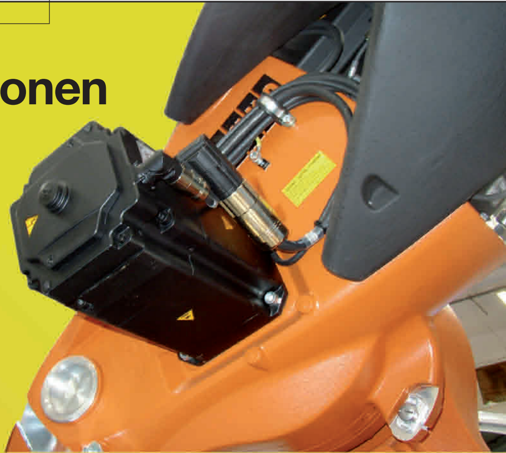
Welchen Stellenwert Steckverbinder in der Antriebstechnik haben, zeigt sich konkret an dem Antriebsmotor eines Kuka-Roboters. Bild: antriebspraxis
